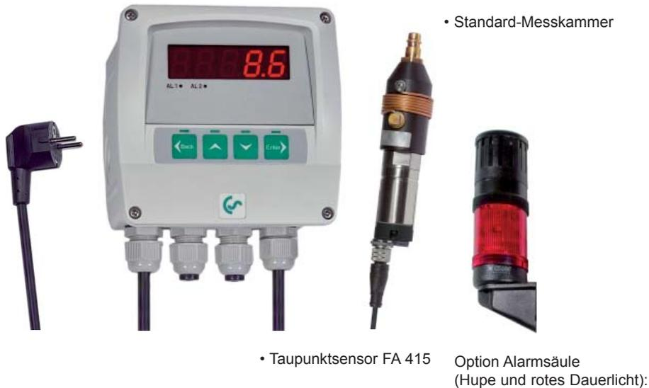
Mit einem Messbereich von -20...50 °Ctd ist das Taupunkt-Set DS 52 mit Alarm die ideale Taupunktüberwachung mit Analogausgang 4...20 mA.
