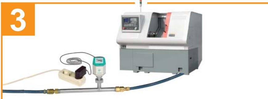
Mit Schnellkupplungen lässt sich der Verbrauchszähler schnell in den Zuleitungsschlauch vor einer Maschine integrieren. Bei Stillstand der Maschine kann die Leckrate ermittelt werden, bei laufender Maschine deren Momentanverbrauch. Die Stromversorgung erfolgt über die Steckdose mit dem Steckernetzteil. Zur Datenaufzeichnung über einen längeren Zeitraum empfiehlt sich der Einsatz des Druckluftmessgeräts DS 300 mobil.
