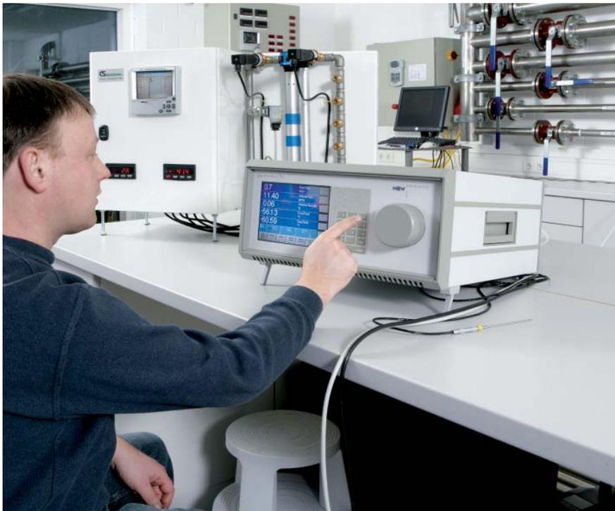
Kalibrierbereich: von  $-80$  bis  $20^{\circ}\text{C}_{\text{td}}$
